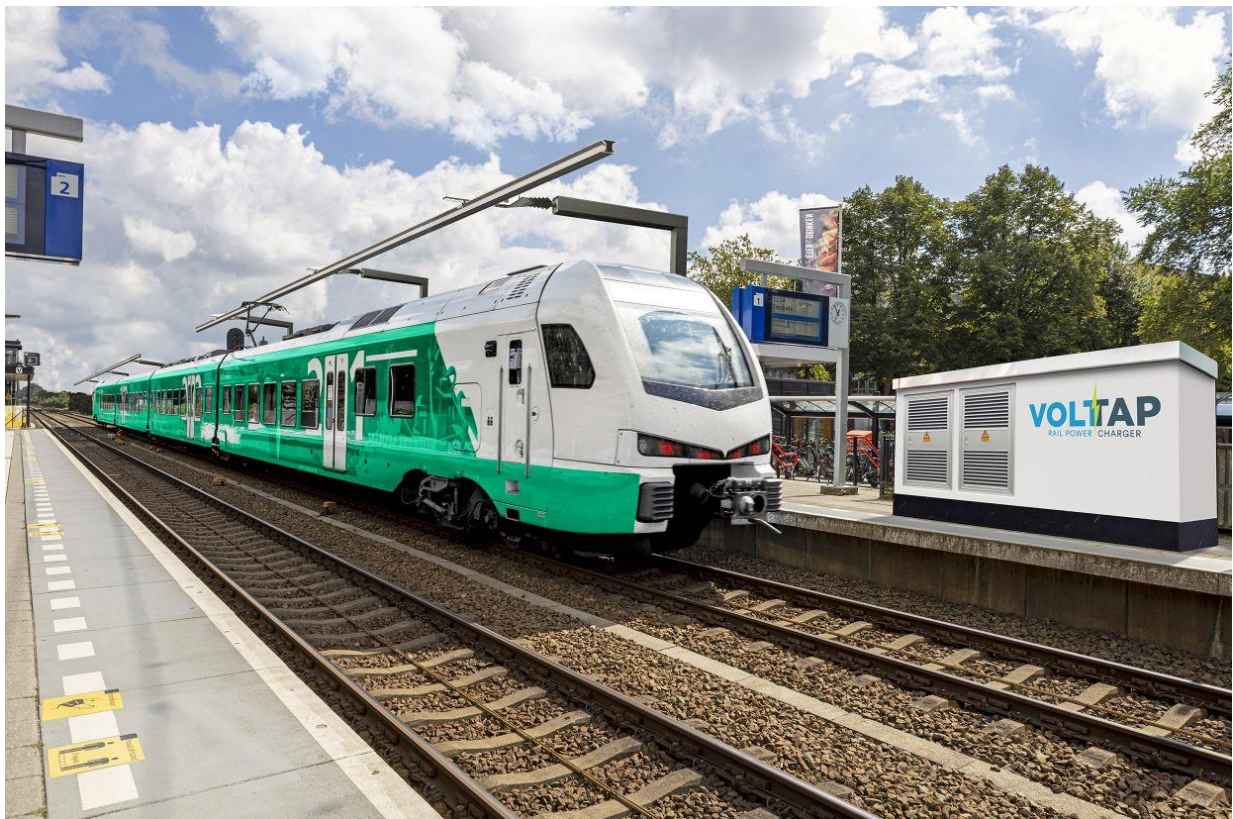
So könnte es aussehen: Eine Voltap-Schnellladestation mit Batteriezug (BEMU) [Visualisierung: Furrer+Frey].
