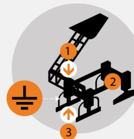
Sichere Kontaktreihenfolge - Erde verbindet zuerst und trennt zuletzt
