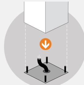
Ein Fundament (ca. 1m<sup>2</sup>), einfache Installation
