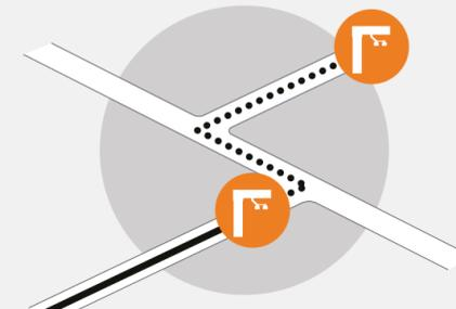
Leichte Erweiterung des Busnetzes; Speisespannung 400 VAC
